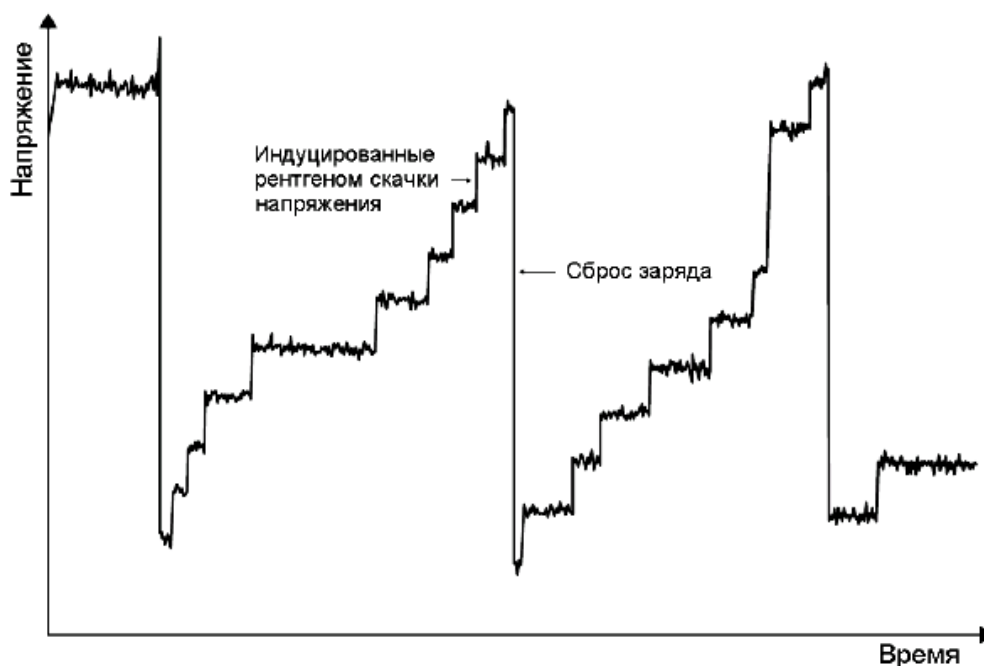
Рис. 9 Иллюстрация работы энергодисперсионного детектора: а - принципиальная электрическая схема; б - типичный вид выходного сигнала предусилителя, вызванного падающим характеристическим излучением MnK\alpha
