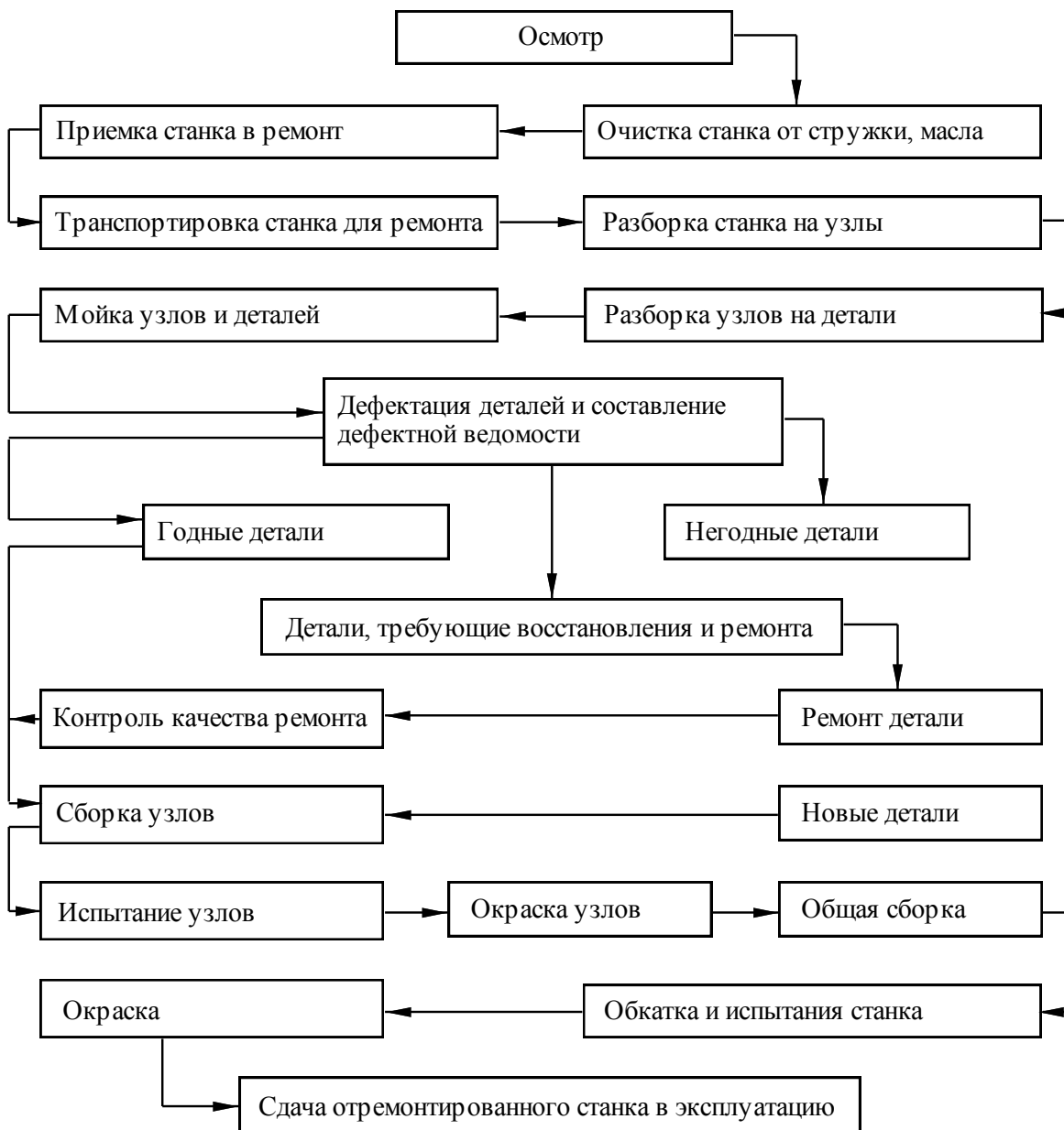
Рисунок 2.1. Общая схема технологического процесса ремонта металлорежущих станков
