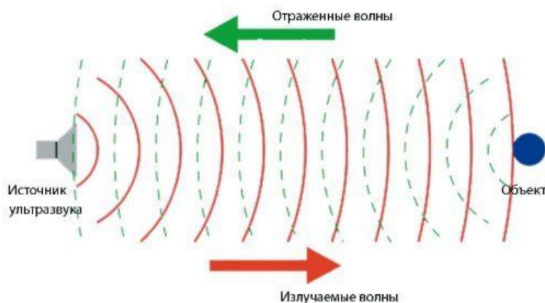
Рис. 1. Принцип работы ультразвуковой системы
