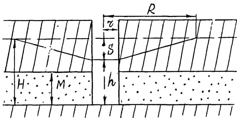
Рис. 2. Приток напорной воды в совершенный колодец
