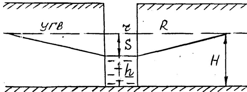
Рис. 3. Приток грунтовых вод в совершенный колодец
