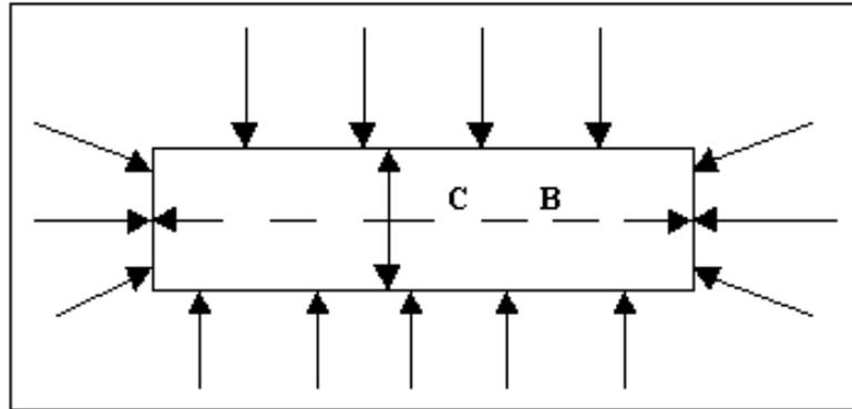
Рис. 7. Приток грунтовых вод с четырёх сторон (в плане): С - ширина канавы; В - длина канавы
