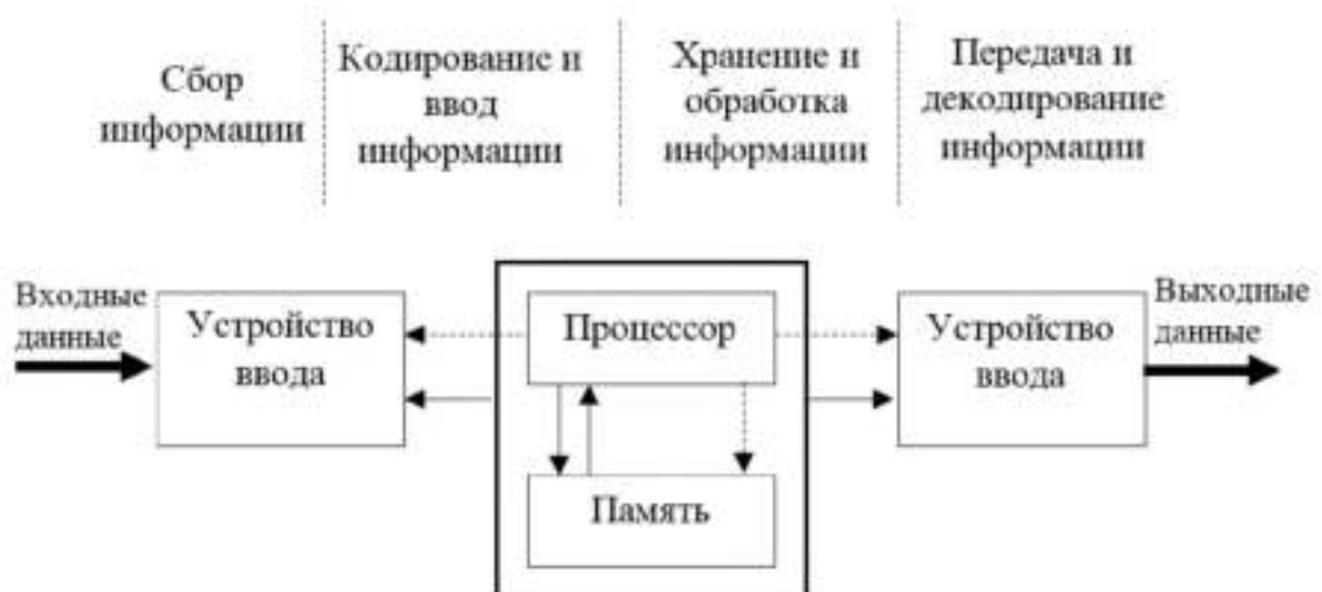
Рисунок 2 - Структурная схема компьютера
