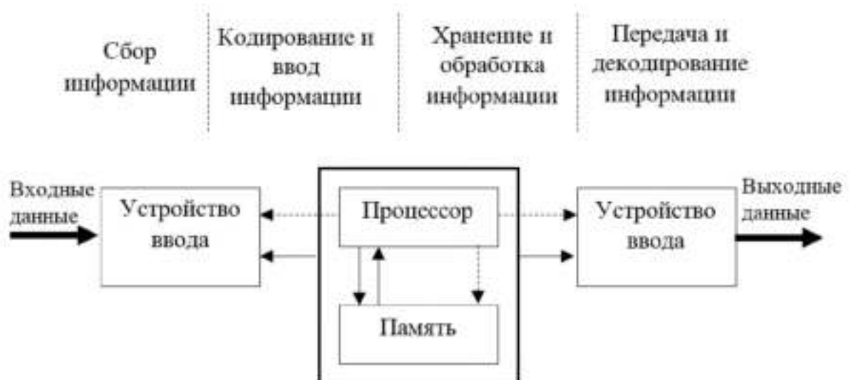
Рисунок 2 - Структурная схема компьютера
