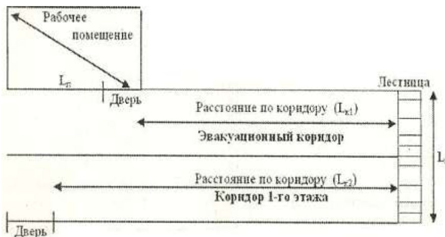
Рисунок 1 – Схема оцениваемого эвакуационного маршрута
