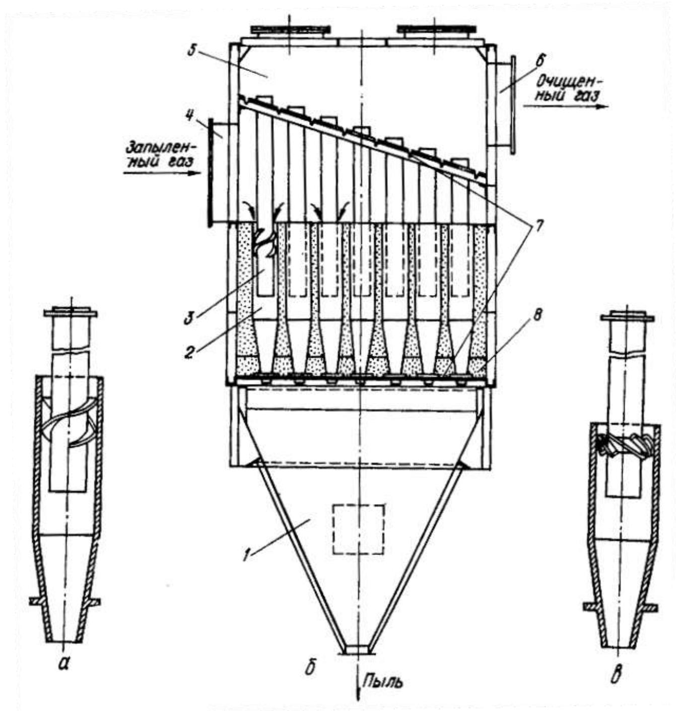
Рис.2. Батарейный циклон с закруткой газа с помощью направляющих аппаратов: а – циклонный элемент с винтовой закруткой газа; б – батарейный циклон; в – циклонный элемент с направляющим аппаратом типа розетки; 1 – бункер; 2 – корпус циклонного элемента; 3 – выхлопная труба; 4 – входной патрубок; 5 – камера очищенного
