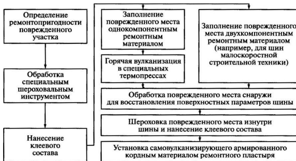
Рис. 6.8. Основные этапы ремонта сквозных повреждений шин
