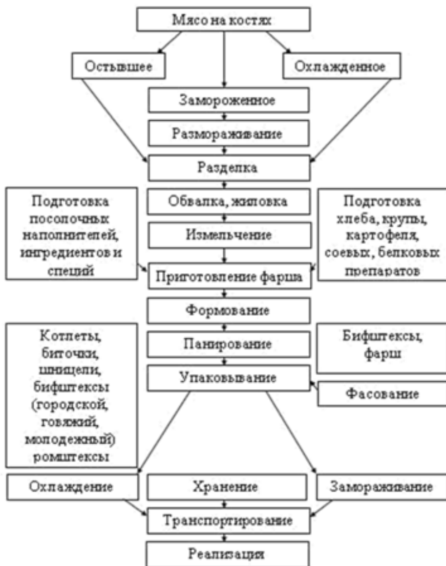
Рисунок 1 - Технологическая схема производства рубленых полуфабрикатов
