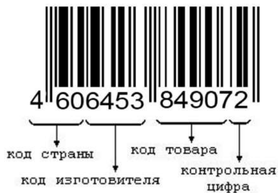
Рисунок 1.1 – Структура штрихового кода EAN-13
