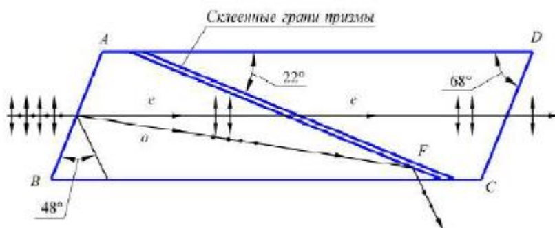
Рис. 15. Ход линейно поляризованных лучей в призме Николя Луч света, входя в кристалл делится на два поляризованных луча e и o. Луч o, обладающий большим коэффициентом преломления,
