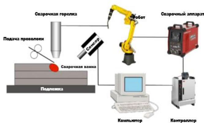
Рисунок 21 – Схема процесса WAAM
