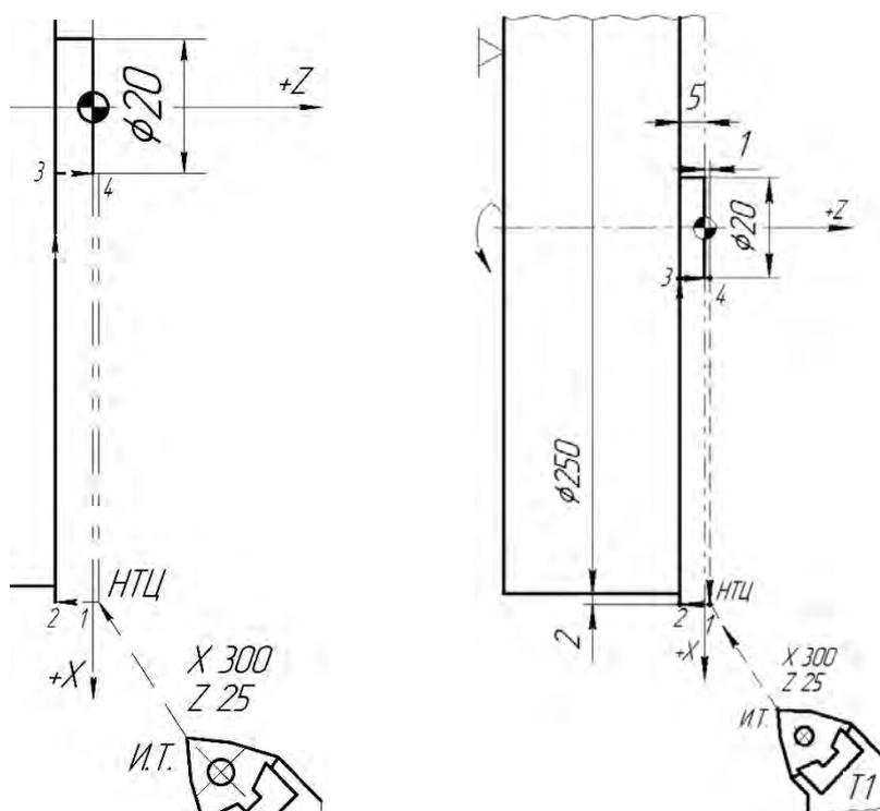
Рис. 1. Схема структуры однопроходного цикла поперечной обработки G71
