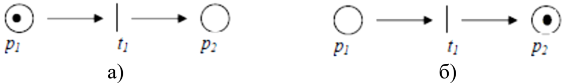
Рисунок 5.2 – Граф простейшей маркированной сети Петри: а) в исходном состоянии; б) после срабатывания перехода
