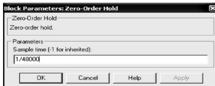
Рисунок 3 – Окно настройки параметров экстраполятора нулевого порядка
