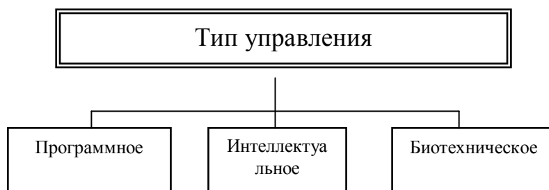
Рис.1. Классификация внутритрубных роботов: а) общая; б) по способу передвижения; в) по типу привода; г) по типу управления
