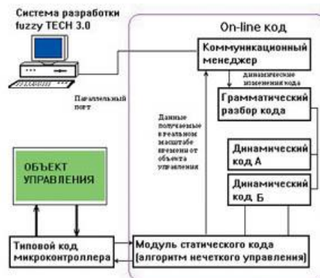
Рисунок 4 – система управления при On-line-оптимизации
