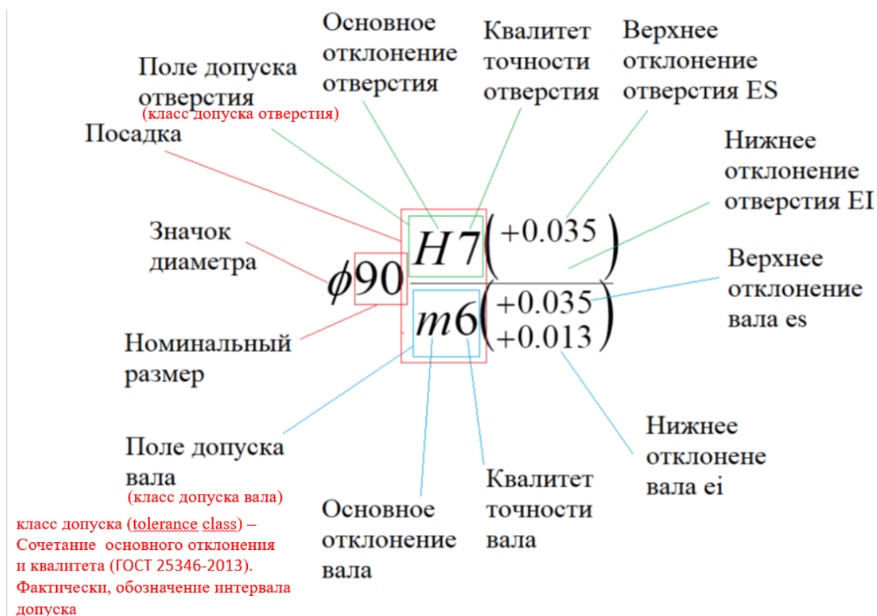
Рисунок 2 Структура комбинированного обозначения посадки
