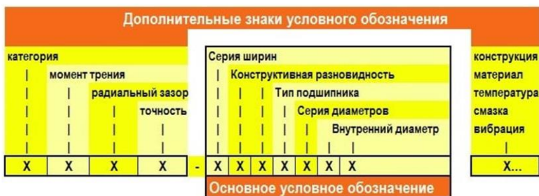
Рисунок 2 Структура условного обозначения подшипников качения
