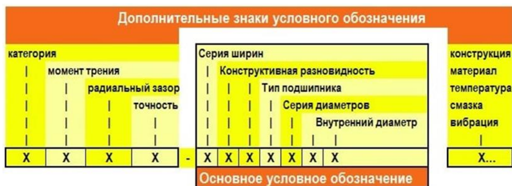
Рисунок 2 Структура условного обозначения подшипников качения
