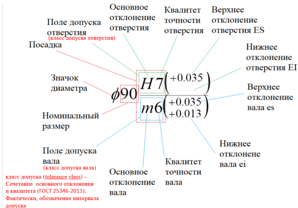
Рисунок 2 Структура комбинированного обозначения посадки
