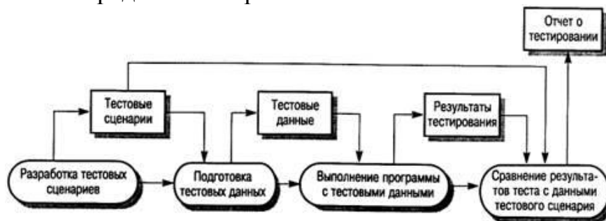
Рисунок 6. Процесс тестирования дефектов
