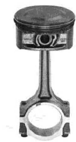
Рисунок 11 – Рабочая поверхность юбки поршня двигателя Ford Duratec покрыта антифрикционным слоем. Разъём нижней головки шатуна выполнен по специальной технологии, с помощью местного разрыва, что обеспечивает исключительно точное совпадение сопрягаемых деталей
