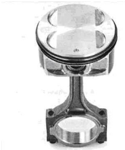
Рисунок 10 – Поршни современных двигателей имеют тенденцию к уменьшению высоты юбки
