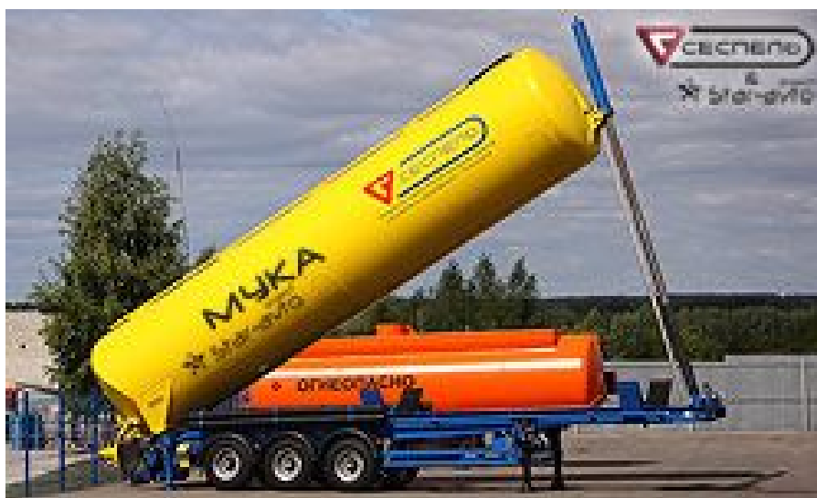
Рисунок 42 - Полуприцеп-муковоз с подъемной цистерной Чебоксарского завода «Сеспель»
