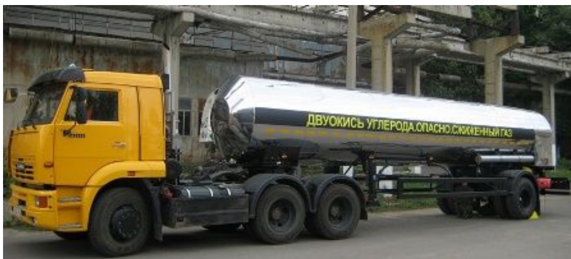
Рисунок 54 - Полуприцеп-цистерна ЦЖУ-10-1,8 для перевозки жидкой углекислоты
