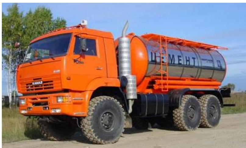
Рисунок 30 - Автоцементовоз АЦЦ-15 на шасси автомобиля КамАЗ-65224
