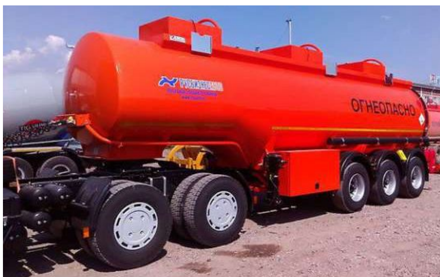
Рисунок 48 - Полуприцеп-бензовоз ППЦ-30 Сеспель 96484
