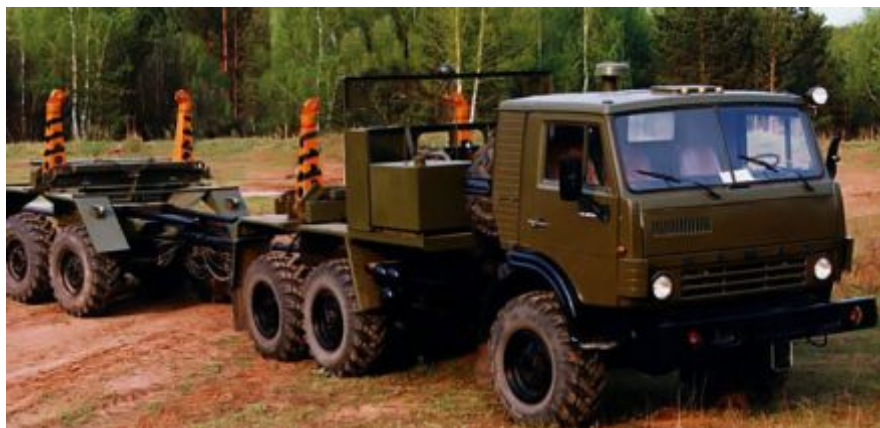
Рисунок 20 - Автопоезд - трубовоз на шасси КамАЗ-43101
