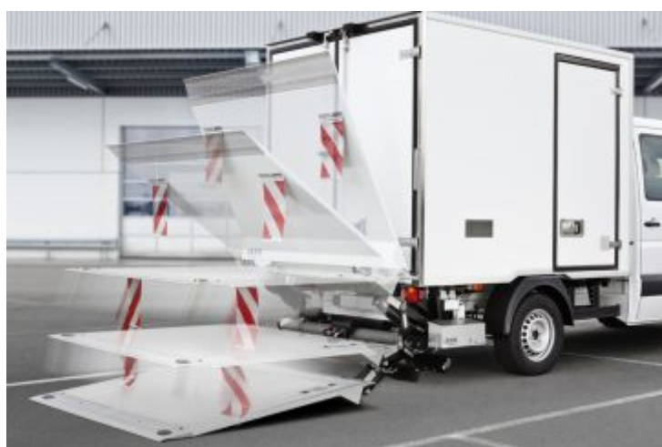
Рисунок 12 - Схема подъема грузоподъемного борта автомобиля-самогрузчика
