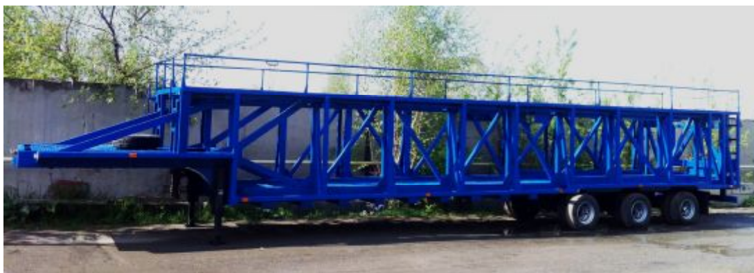
Рисунок 25 - Кассетный полуприцеп-панелевоз TEXOMS 983960
