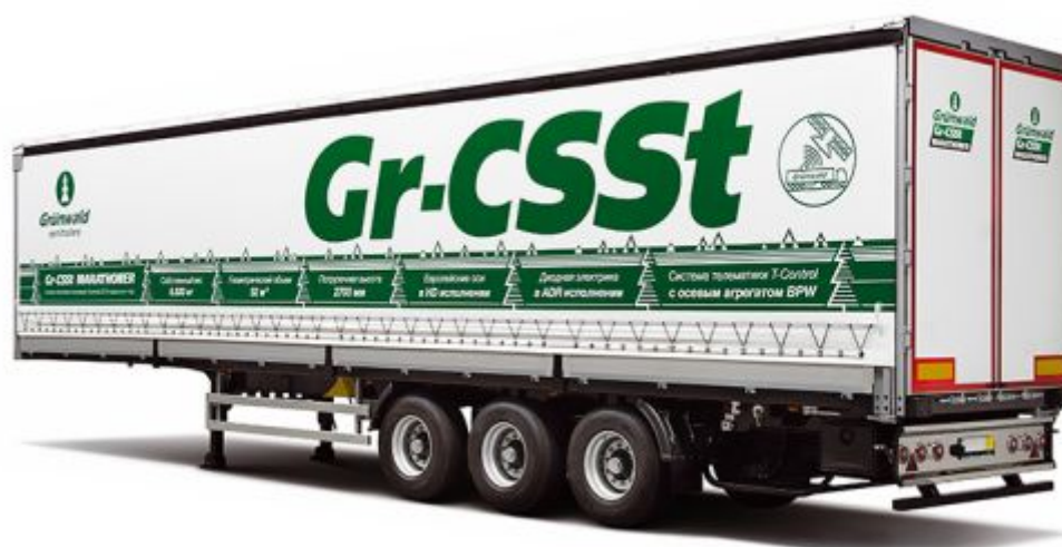
Рисунок 57 - Шторно-бортовой полуприцеп Gr-CSSt MARATHONER
