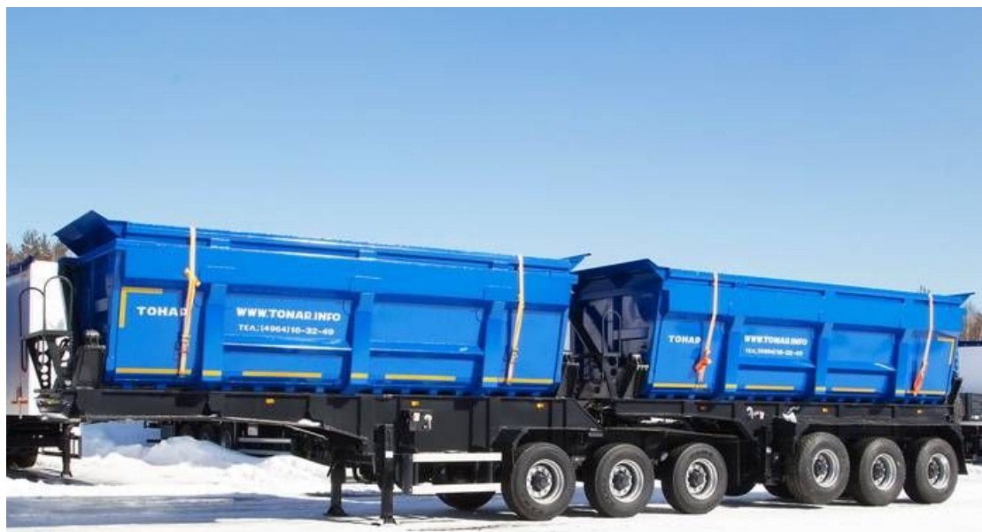
Рисунок 6 - Двухсекционный полуприцеп Тонар-9540 с боковой разгрузкой
