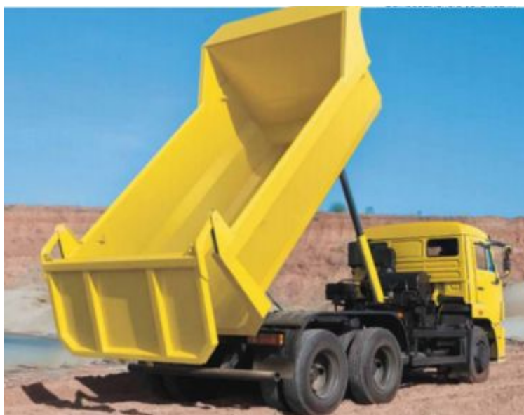
Рисунок 9 - Автомобиль-самосвал КамАЗ-65115 с принудительной выгрузкой груза при помощи наклона кузова
