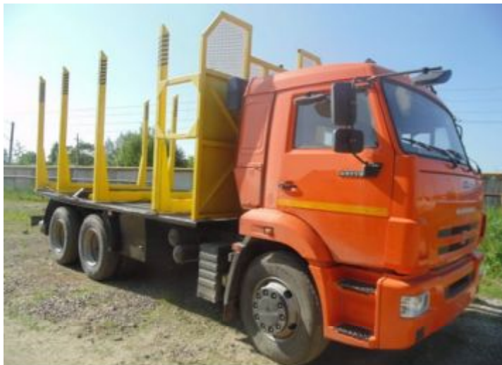
Рисунок 17 – Автомобиль - сортиментовоз на шасси КамАЗ-65115
