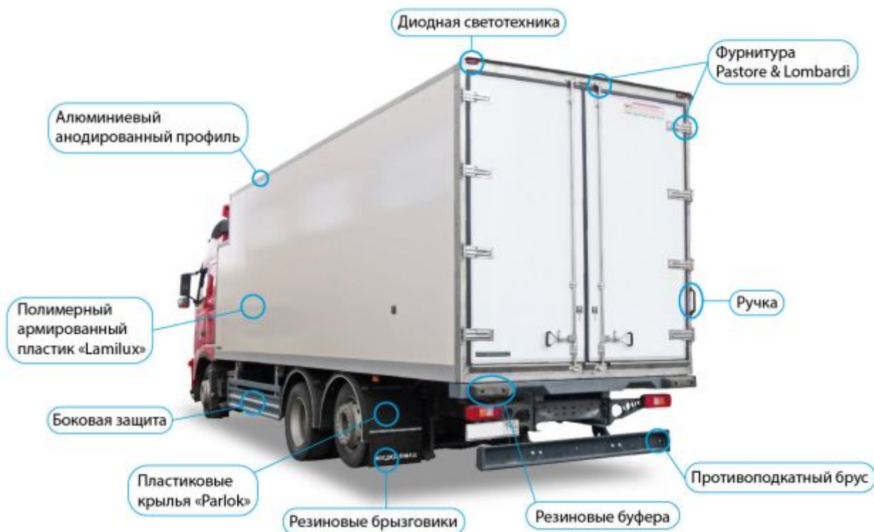
Рисунок 61 - Конструкция фургона-рефрижератора
