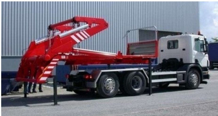
Рисунок 8 - Автомобиль-самопогрузчик с порталным краном
