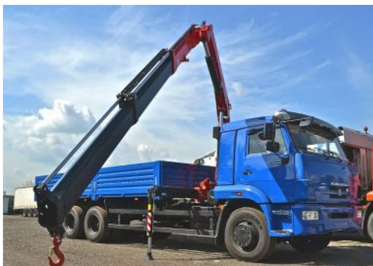
Рисунок 7 - Кран-манипулятор на шасси КамАЗ-65117 с размещением между кабиной и грузовой платформой
