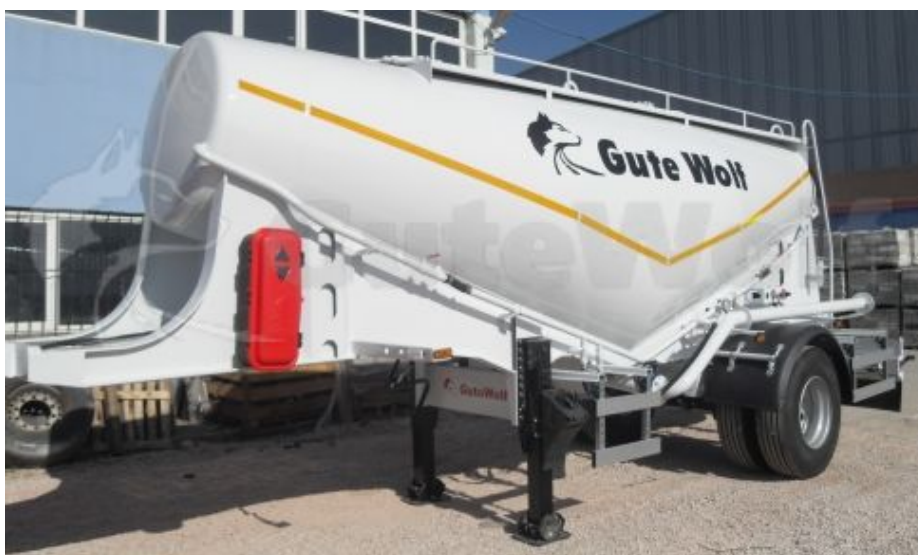
Рисунок 40 - Полуприцеп-муковоз с цистерной V-образной формы
