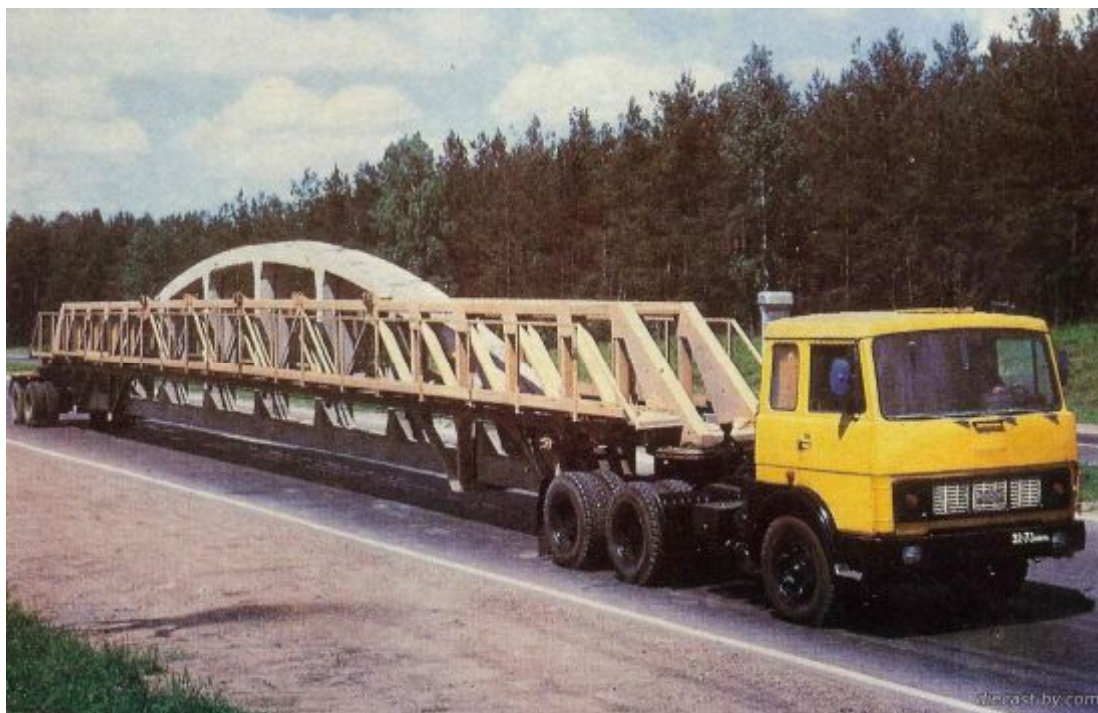
Рисунок 26 – Полуприцеп - фермовоз МАЗ-9998
