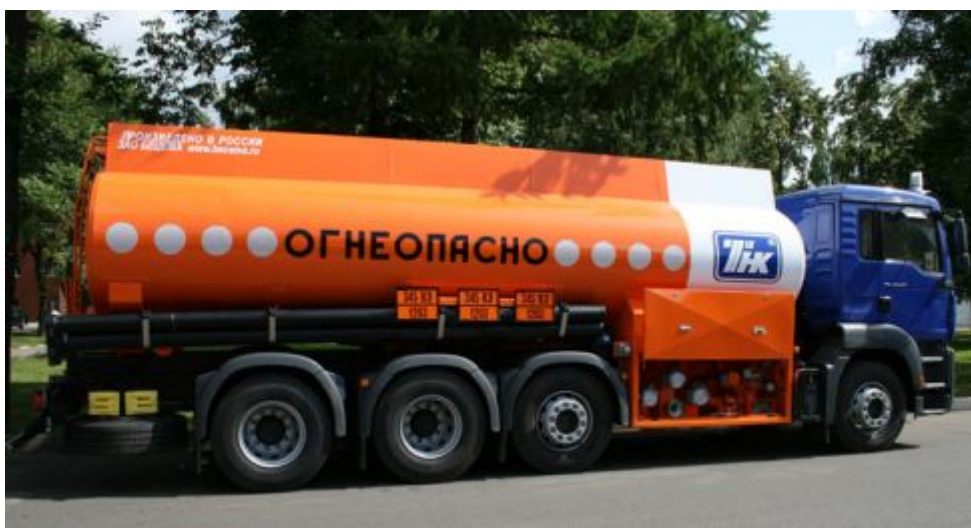
Рисунок 47 - Автоцистерна для светлых нефтепродуктов БЦМ-173 на шасси MAN TG-A
