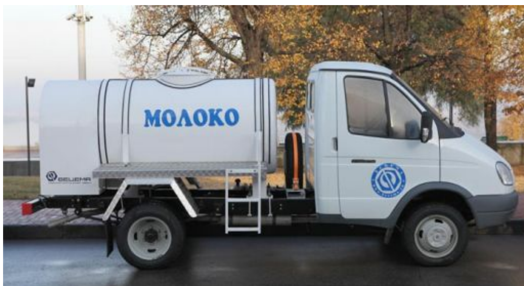
Рисунок 46 - Молоковоз БЦМ-226 на шасси ГАЗ-3302
