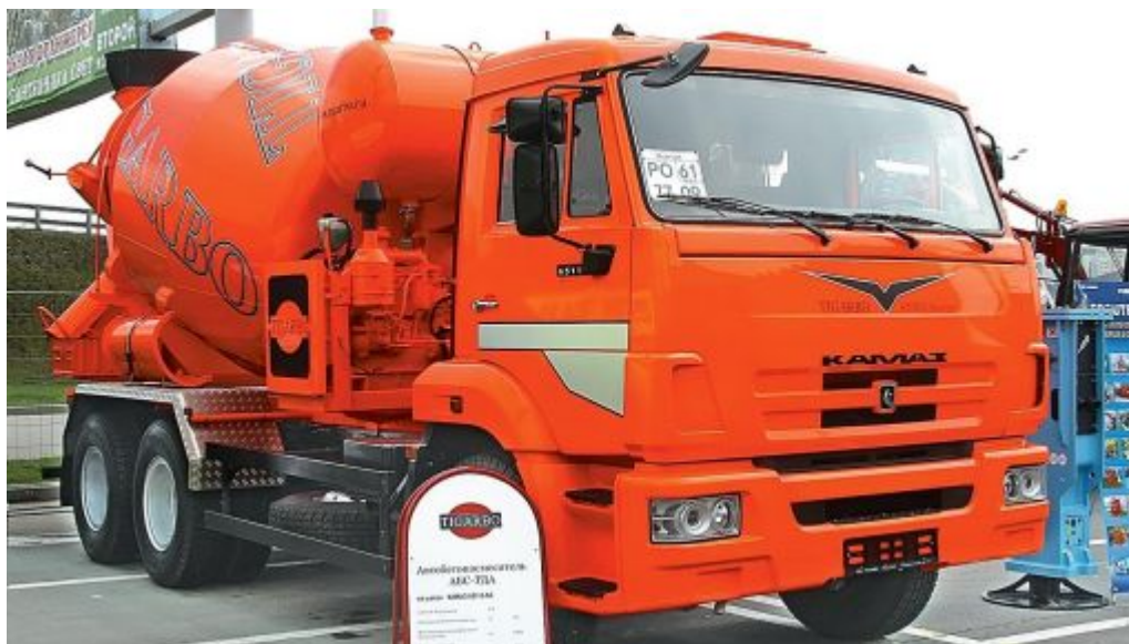
Рисунок 37 – Автобетоносмеситель TIGARBO АБС-7ДА вместимостью 7 м 3 на шасси КамАЗ-65115
