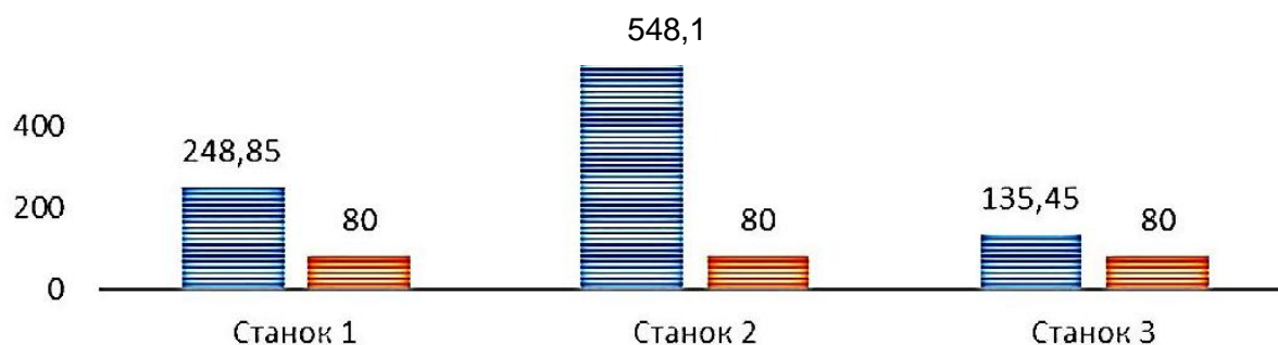
Рис.7 Сравнение времени такта и времени цикла после изменений для станка 2 – работа над заказом в одну смену: ■ - время такта; ■ - время цикла
