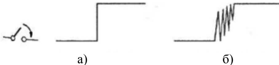
Рисунок 5.2 – Явление дребезга контактов. а) – теоретический сигнал; б) – реальный сигнал
