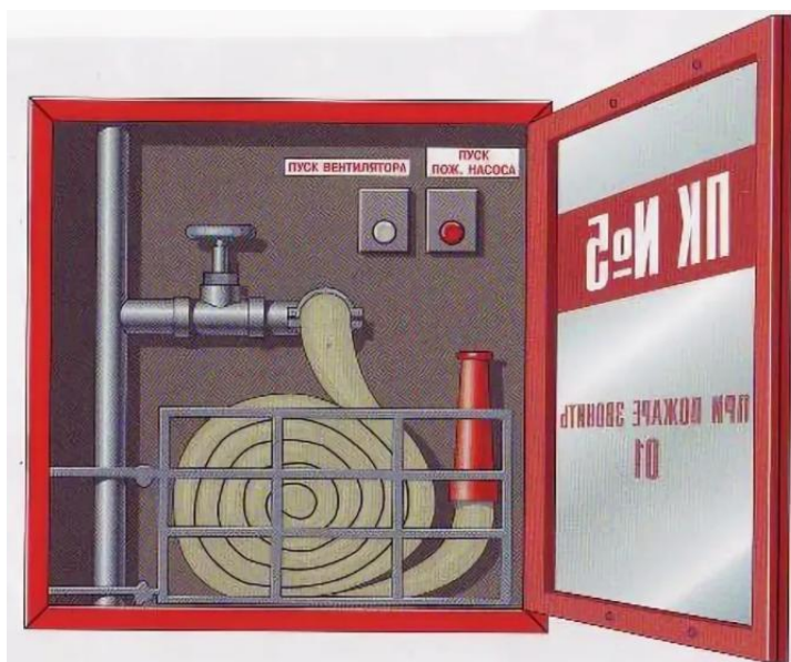
Рисунок 7 Пожарный кран с пожарным рукавом
