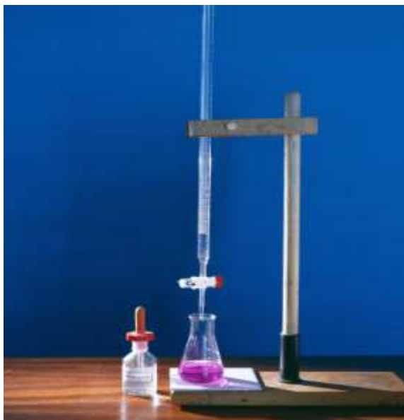
Рисунок 4 Установка для проведения операции титрования
