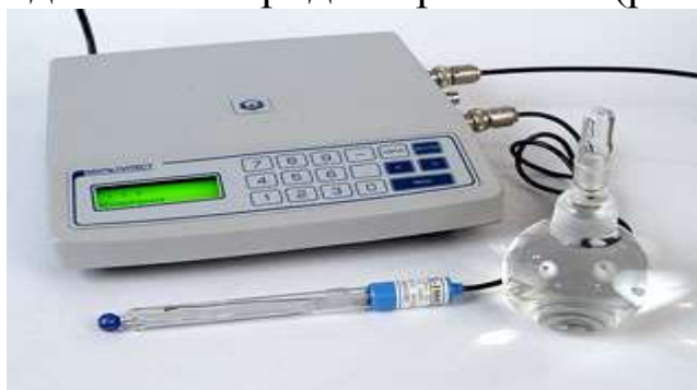
Рисунок 4 – Иономер - мультитест ИПЛ-513 со стеклянным электродом
