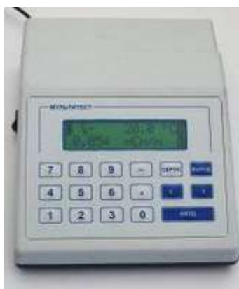
Рисунок 3 – Кондуктометр -мультитест КСЛ-101
