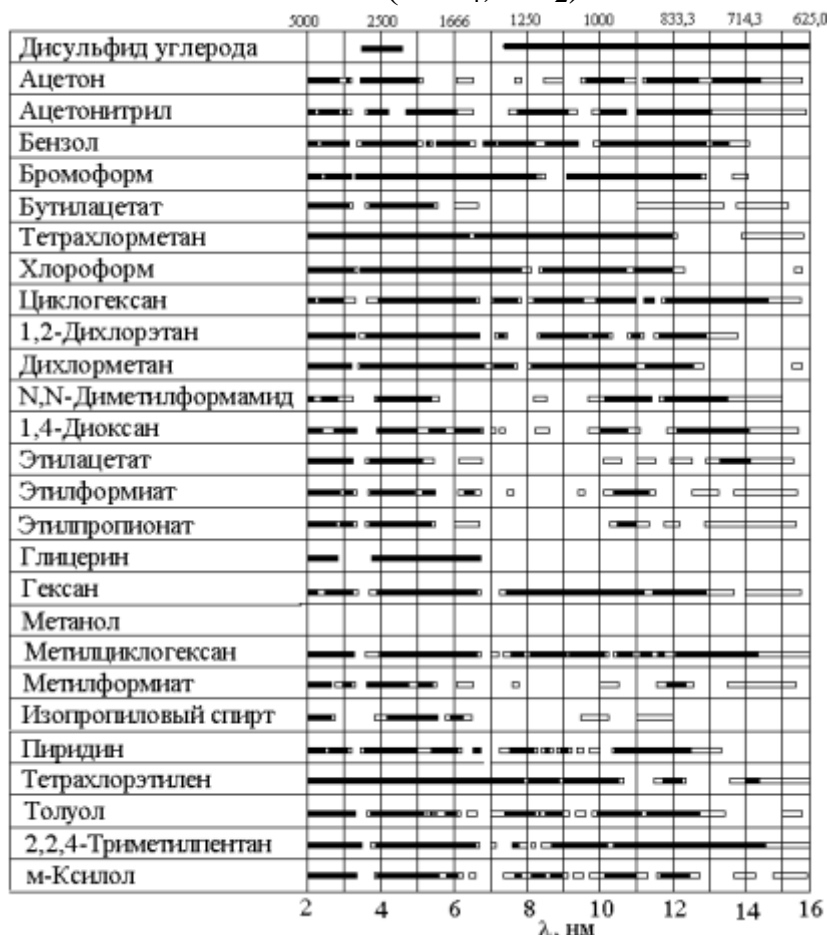
Рис. 15. Прозрачность «спектрально чистых» органических растворителей, применяемых в ИК-спектроскопии в диапазоне 5000\text{--}625\text{ см}^{-1} при толщине слоя растворителя 0.11\text{ мм} /8/. Зачерненным прямоугольникам отвечает диапазон 80-100% пропускания, незачерненным - 60-80% пропускания.
