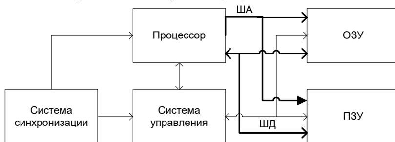
Рисунок 1 – Вариант схемы процессорного ядра
