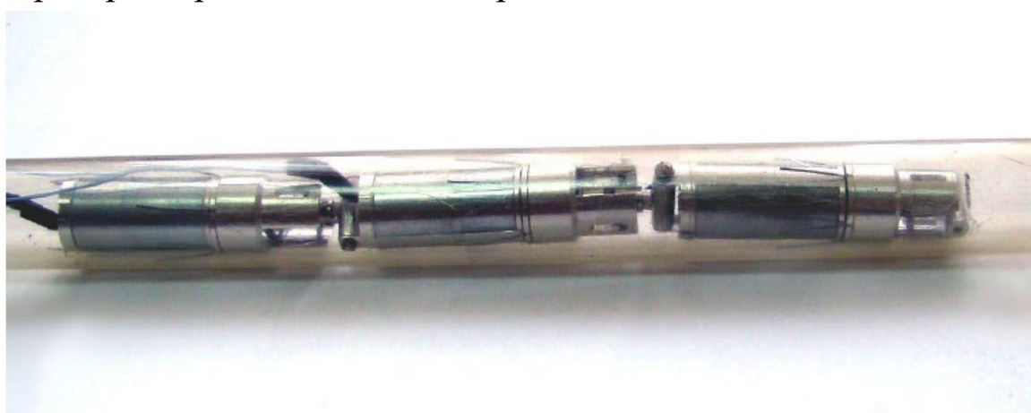
Рисунок 3.5 – Внешний вид прототипа трехзвенного вибрационного внутритрубного мобильного робота
