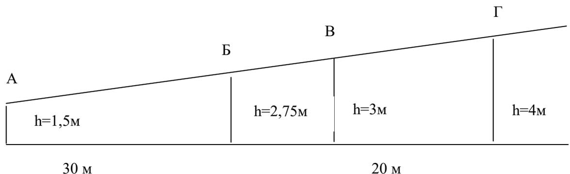
Рис. 6.1 - Продольный разрез траншеи
