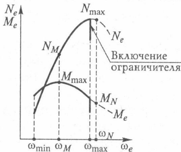
Рисунок 2 - Внешняя скоростная характеристика бензинового двигателя с ограничителем угловой скорости коленчатого вала
