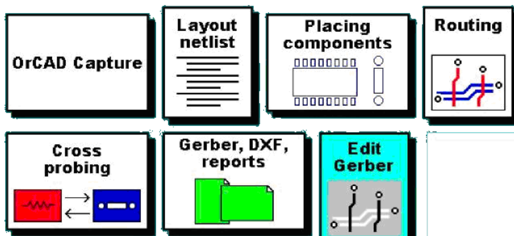
Рис. 1. Основные этапы создания проекта печатной платы с помощью графического редактора Layout
