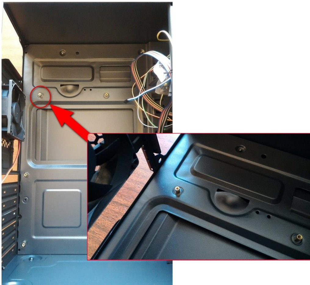
Рис. 15 - Установка стоек крепления системной платы
