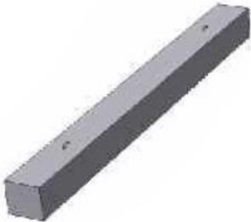
Рисунок 1.15 - Свая с плоским нижним концом
