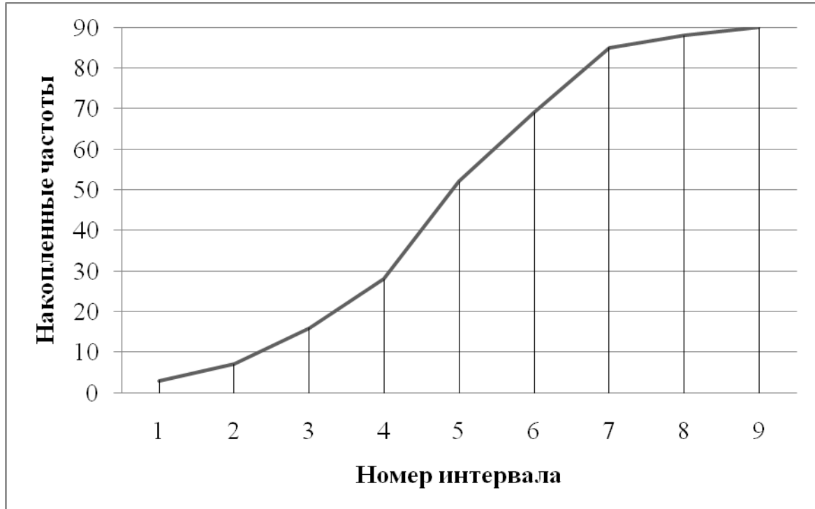
Рис. 2 - Полигон накопленных частот распределения значений диаметра вала
