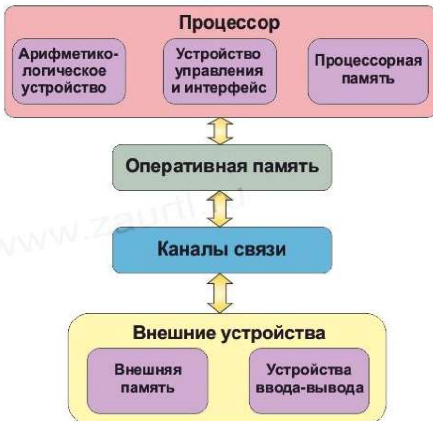
Рисунок 1 – Упрощенная структурная схема ЭВМ
