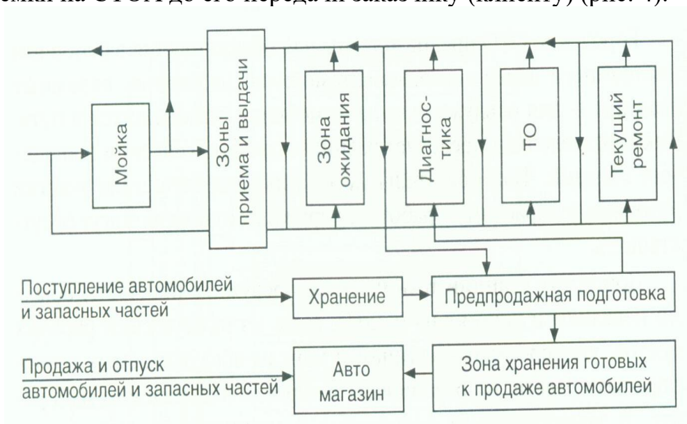
Рис. 4 Схема технологического процесса на СТОА
