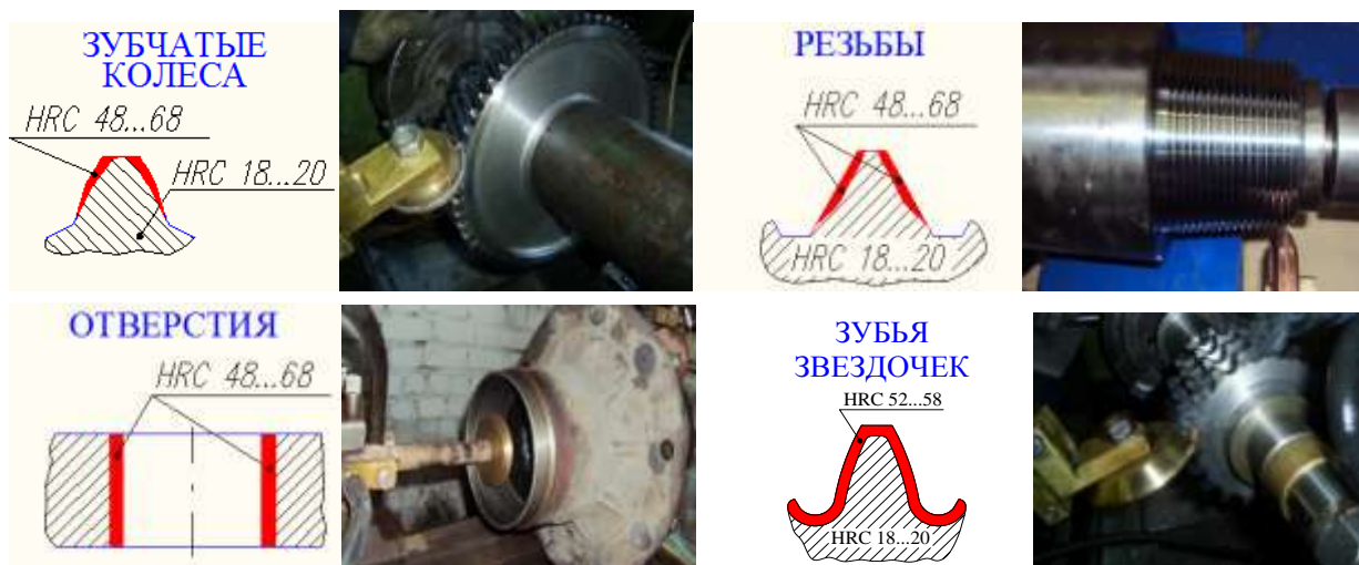
Рис. 2. Принципиальные схемы и фрагменты ЭМПЗ поверхностей деталей
