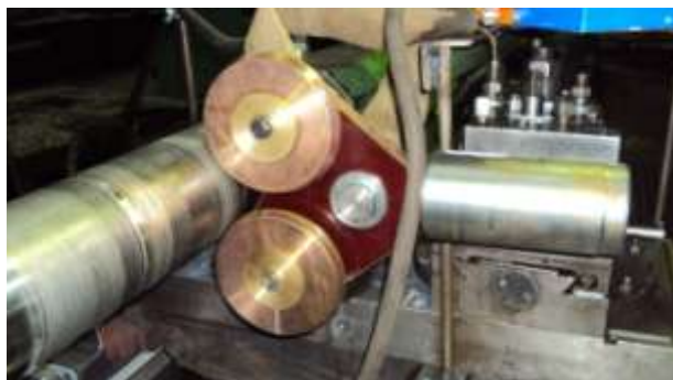
Рис. 6. Фрагмент ЭМПЗ вала с применением двухроликовых приспособлений
