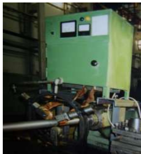
Рис. 7. Фрагмент ЭМПЗ штока гидроцилиндра с применением трехроликового приспособления
