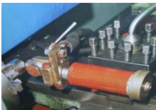
Рис. 5. Державка телескопическая и ее крепление в резцедержателе токарно-винторезного станка
