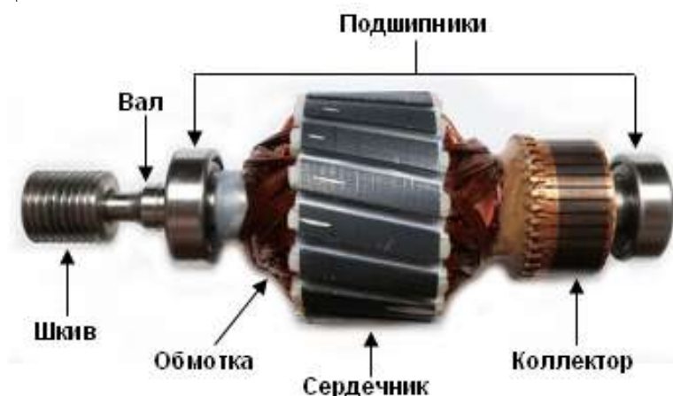
Рис.2 Ротор (якорь) коллекторного двигателя
