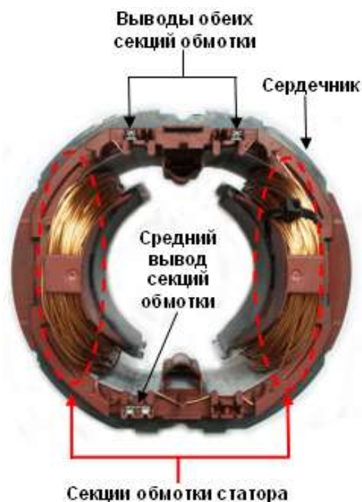
Рис.3 Статор коллекторного двигателя (вид с торца)
