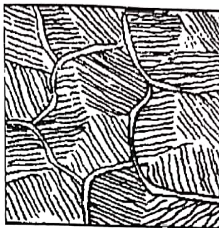
Рисунок 14. Структура заэвтектоидной стали: а) микроструктура (перлит и вторичный цементит); б) схема зарисовки микроструктуры
