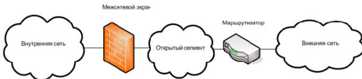
Рис. 5.1b - подключение межсетевого экрана с двумя сетевыми интерфейсами при выделении открытого сегмента внутренней сети
