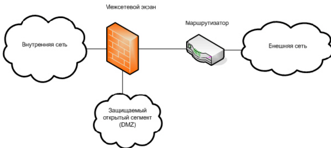
Рис. 5.1с - подключение межсетевого экрана с тремя сетевыми интерфейсами для защиты внутренней сети и ее открытого сегмента
