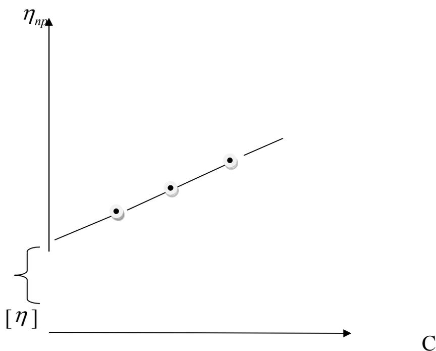
Рисунок 1- Зависимость вязкости от концентрации раствора
