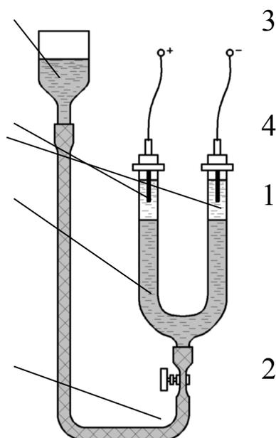
Рисунок 3 - Прибор Кёна для изучения электрофореза
