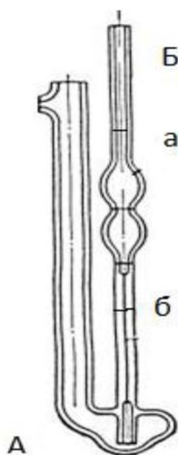
Рисунок 2- Схема капиллярного вискозиметра
