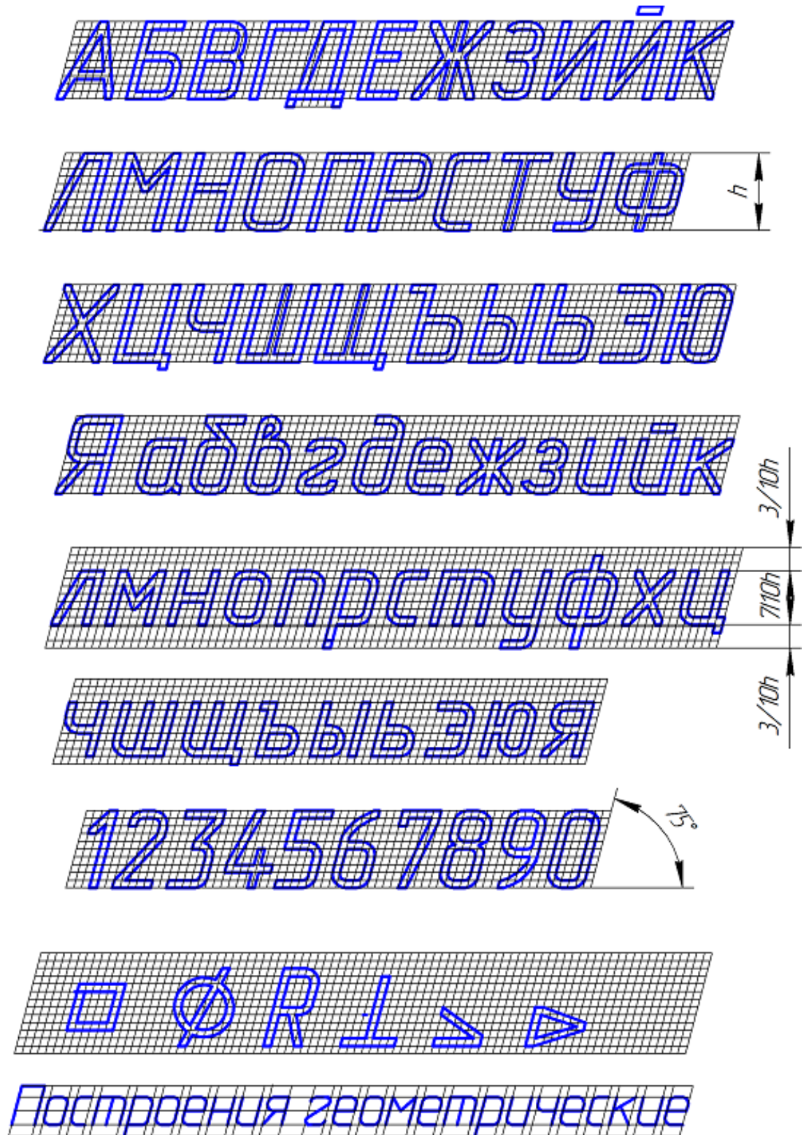
Рисунок 1.4 – Шрифт типа Б с наклоном
