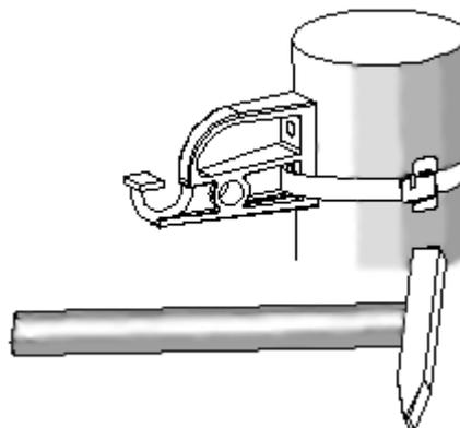
Существует еще один, более рациональный способ монтажа ленточного узла крепления, в котором лента предварительно не отрезается, но дает экономию до 3 см ленты на одном хомуте. Эта экономия может оказаться существенной, особенно при больших объемах работы. Так, при монтаже узлов с общим расходом ленты в 1000 м можно сэкономить 30 м дорогостоящей ленты из нержавеющей стали.
