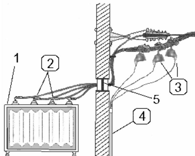
Герметизацию кабельного прохода (поз.5) можно выполнить с помощью надувного уплотнителя типа **RDSS**, разработанного фирмой "Райхем".
