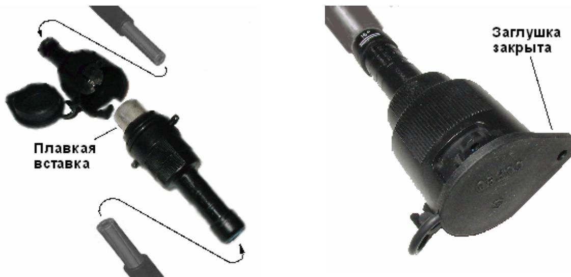
Предохранитель применяется для провода сечением **16 мм<sup>2</sup>** - модификация **CCFBD 16-16**, и **25 мм<sup>2</sup>** - модификация **CCFBD 25-25**. Контактное соединение предохранителя с концами провода СИП выполняется опрессовкой с обеих сторон с помощью ручного пресса **SIMPI**, **SIMECA** или **SIMABLOC** с одной матрицей **E140**.
