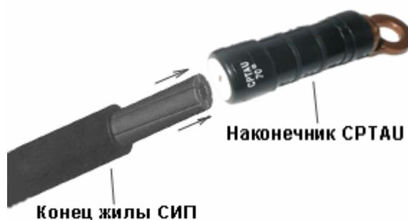
Оголенный конец каждого из проводников СИП вставляется в свой наконечник и с помощью ручного гидравлического прес- са, например типа **SIMABLOC 55**, или ручного прес- са типа **SIMECA** и шестигранных мат- риц типа **4E140 - E83, 4E173, 5E21** запрессовывается внутри наконечника.
