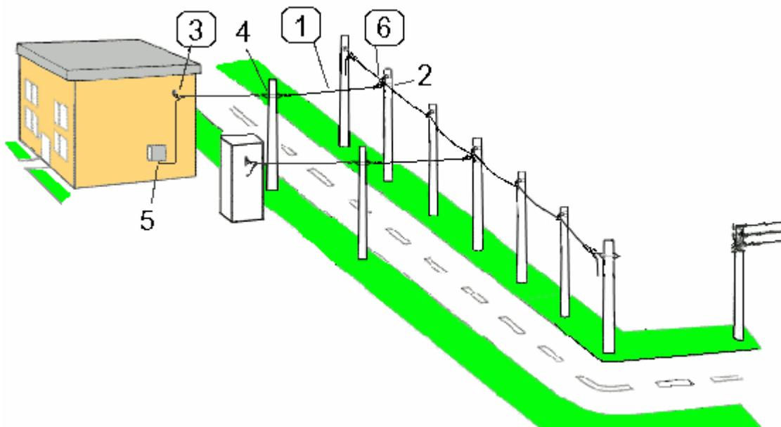
**Закрепление проводов в начале ответвительной линии** (поз.2) осуществляется с помощью комплекта анкерного крепления: зажима и кронштейна.
