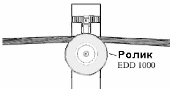
Раскаточные ролики типа **EDD 1000** и **EDD 1700** имеют пласти- ковое покрытие и обустроены уст- ройством для подвешивания с лен- той и зажимом.
