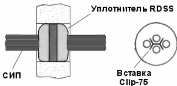
Для уплотнения проводников СИП в жгуте применяется уплотнительная вставка типа Clip, которая препятствует проникновению влаги внутрь здания между проводниками СИП.
