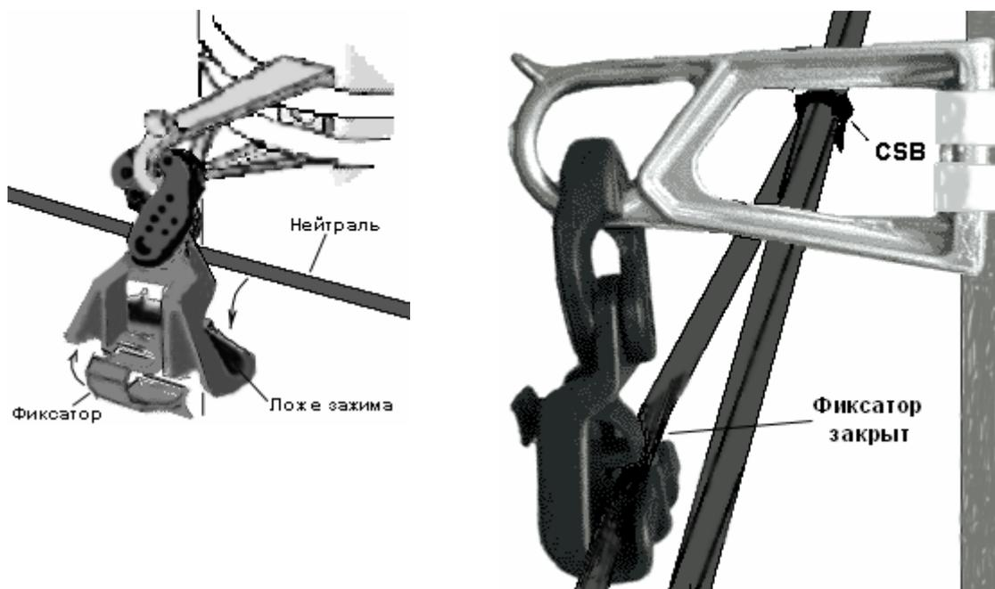
При значительных углах изгиба ВЛИ (при углах изгиба больших, чем указано выше) и на угловых опорах необходимо использовать зажимы анкерные типа **РА 1000, РА 1500, РА 2000, РА 95-2000**.
