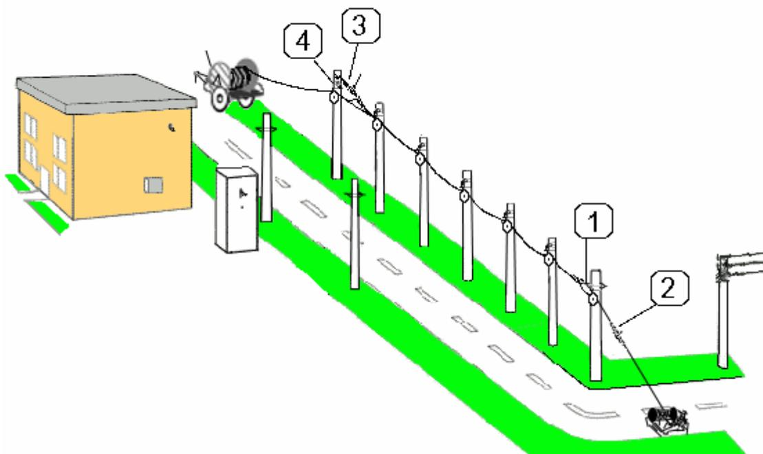
Натянутая ручной лебедкой линия на ближней (начальной) опоре закрепляется с помощью анкерного зажима (поз.4).
