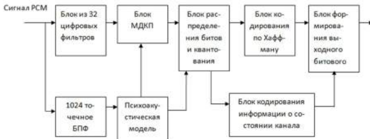
Рис. 1. Структура кодера mp3
