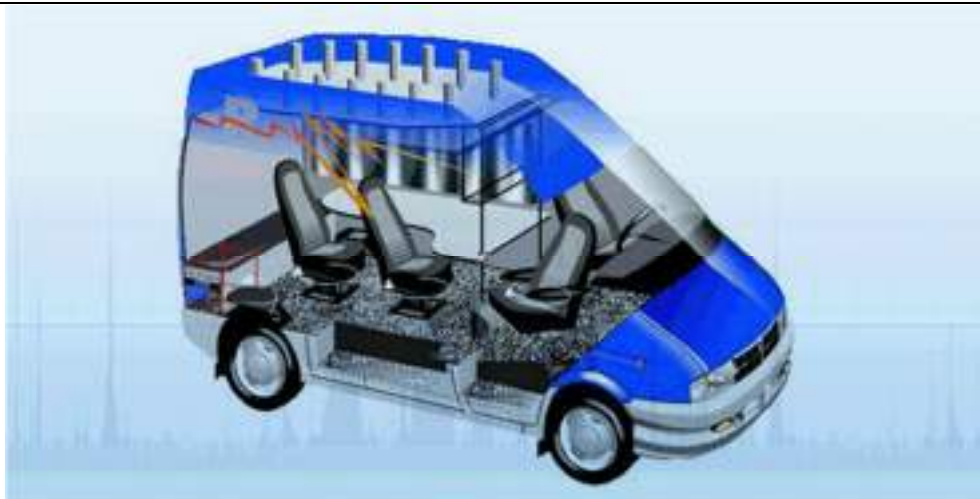
Рис. 1. Структура комплекса пеленгования источников радиоизлучений Барс МПИ-2
