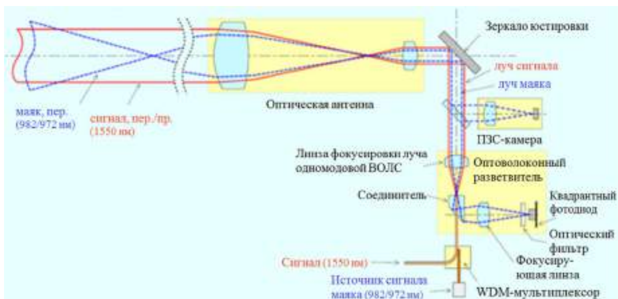
Рис. 3. Устройство терминала АОЛС-одномодовая ВОЛС
