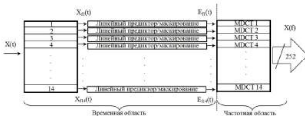
Рис. 4. Линейный предиктор в структуре ортогонального кодера
