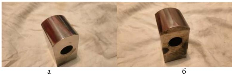
Рис. 7. Шлаг-бакен с исходной и изношенной поверхностью: а – исходная поверхность (до эксплуатации); б – изношенная поверхность
