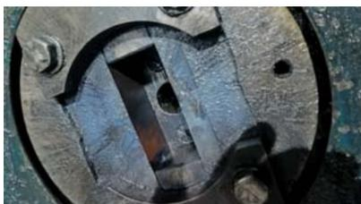
Рис. 3. Элементы конструкции рабочей части шпинделя ротационно-ковочной машины без бойков
