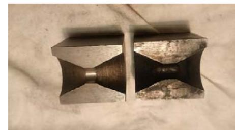
Рис. 5. Ковочные бакены: слева – новый бакен, справа – бакен с изношенным ковочным каналом
