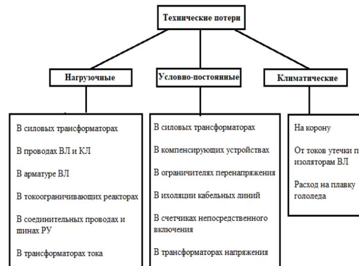
Рисунок 1 – Структура электрических потерь в распределительных сетях
