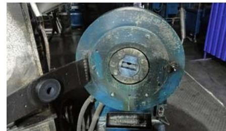
Рис.1. Типовая конструкция ротационно-ковочной машины
