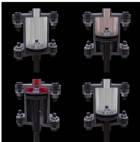
Рис. 5. Выборочная раскадровка четырех фаз анимации работы пневматического цилиндра
