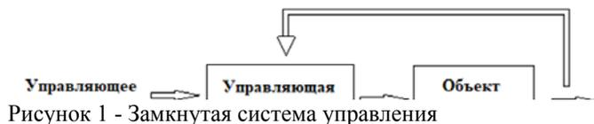
Рисунок 1 - Замкнутая система управления
