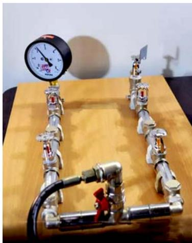
Рисунок 1. Установка спринклерного пожаротушения
