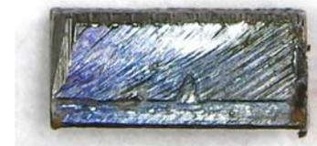
Рис.4 Образец стали СтЗсп в водном растворе бикарбоната натрия (1 %)
