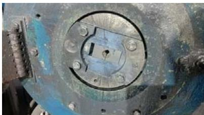
Рис. 4. Элементы конструкции рабочей части шпинделя ротационно-ковочной машины со вставленными в паз шпинделя бойками
