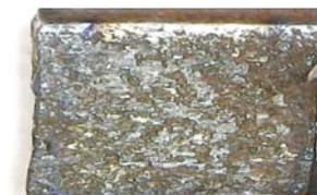
Рис. 6 Образец стали марки СтЗсп после пребывания в водном растворе Рофамина Т (1%)
