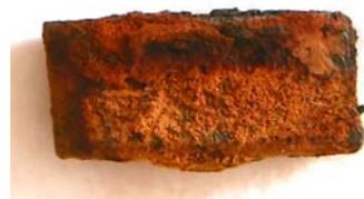
Рис.2 Образец стали СтЗсп в дистиллированной воде
