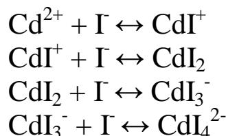
Рассчитаем молярные доли всех частиц, присутствующих в растворе, принимая, что  $[\text{I}^-] = C_{\text{I}} = 2 \text{ M}$ , так как  $C_{\text{I}} \gg C_{\text{Cd}}$ :
