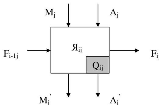
Рисунок 3 - Структура ячейки для функций поиска на совпадение и на несовпадение,
