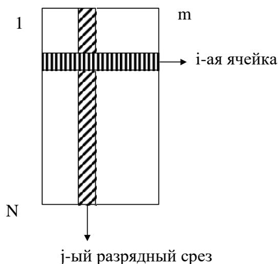
Рисунок 1 - Формирование ячейки и разрядного среза памяти.
